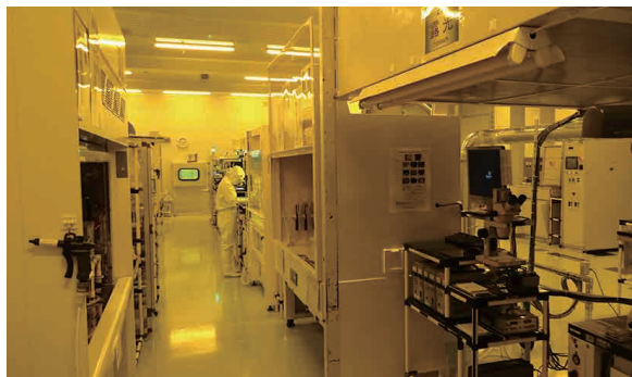
MEMSジャイロのセンサエレメント(音さ部分)フォト工程。クリーンルームの清浄度はクラス100で管理されたエリアです。ここでは、ロータリーエンコーダのガラスディスクも製造します。
