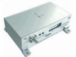
角速度と加速度を検出し、乗心地レベルを計算。GPSによる位置情報と対応させることで現在の乗心地状況を測定。
