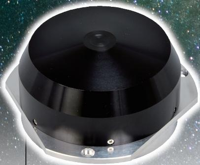
超小型衛星の姿勢制御に用いるホイール。3軸又は4軸で構成されます。ホイールの角速度を加減速し、その運動量の変化を衛星側と連動して姿勢制御を行います。
