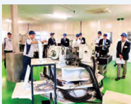
▲3軸6自由度振動台の実演
