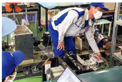
EV駆動用モータ軸のトルクリップルの検出と制御をデモ機を用いて解説
