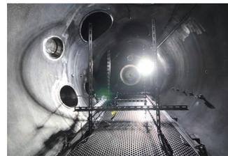
照明、カメラ、燃料噴霧ノズル、センサーなどが設置された槽内
