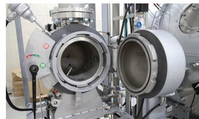
サブチャンパーでは実験に使用した燃料の燃焼確認を行う
