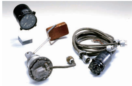
九七式油量計 左から指示器、受感部(レバー型)、受感部(切替ス Mitchell)
