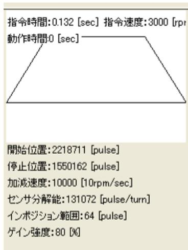
9. 「ダウンロード」ボタンを押し、確認画面の「はい」を押すと、設定した動作パターンをドライバへダウンロードします。正常にダウンロードが完了すると、完了画面が表示されます。
