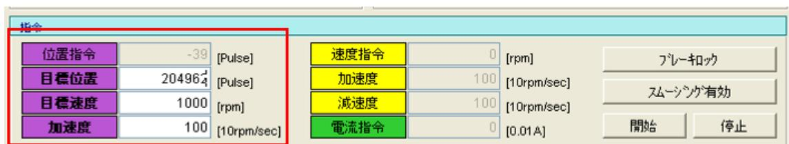
3. 【サーボコマンド】にて「サーボオン」「プロファイル開始」にチェックを入れ、モータをサーボオン状態にします。
