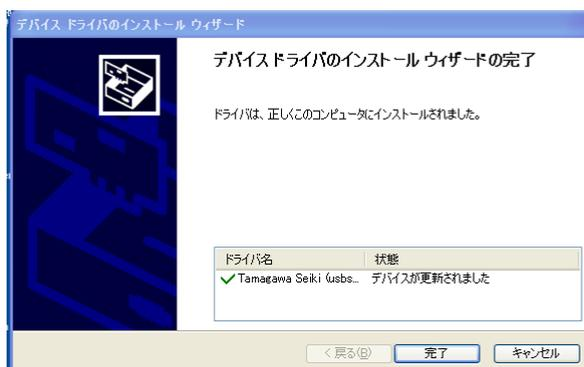
5. 正常にインストールが完了すると、完了画面が表示されますので、「完了」をクリックします。
