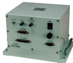
3軸角度・角速度・加速度出力 (アナログ・デジタル) 3-axis angle · angular speed · acceleration output (Analogue / Digital)
