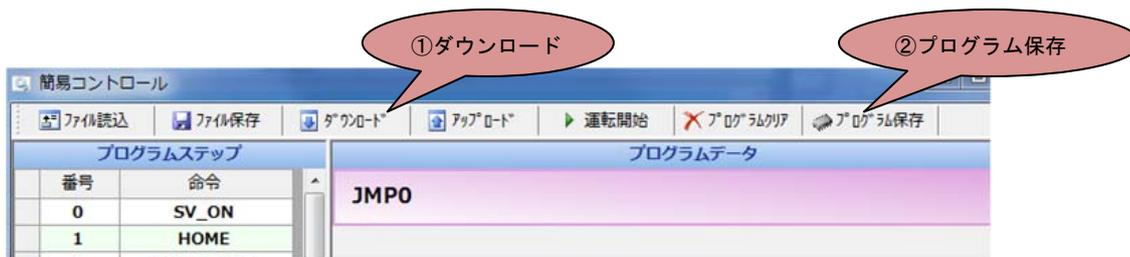
次に、プログラムを実行する場合専用アプリケーションから制御モードを「簡易コントロールモード」に設定し、サーボコマンドで「サーボ ON」を行います。これによりプログラムスタート指令が入力され、簡易コントロール機能のプログラムが実行されます。
