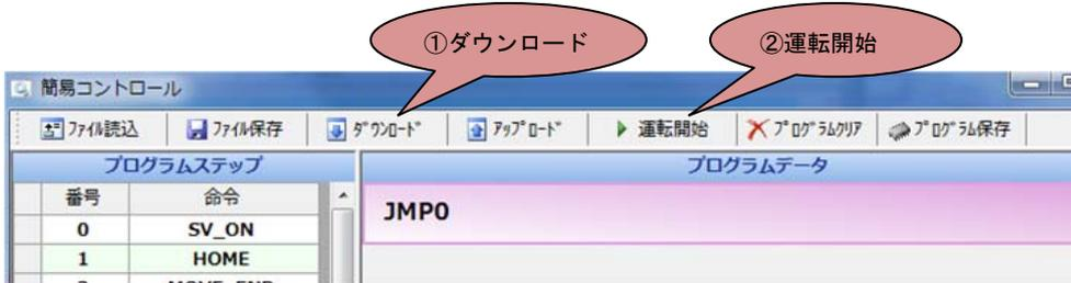
これによりプログラムを試運転させることができます。この試運転ではプログラムスタート指令を入力することなくプログラムを実行できます。試運転中は現在実行中のステップが黄色で表示されます。プログラムを中断する場合は「運転停止」をクリックします。
